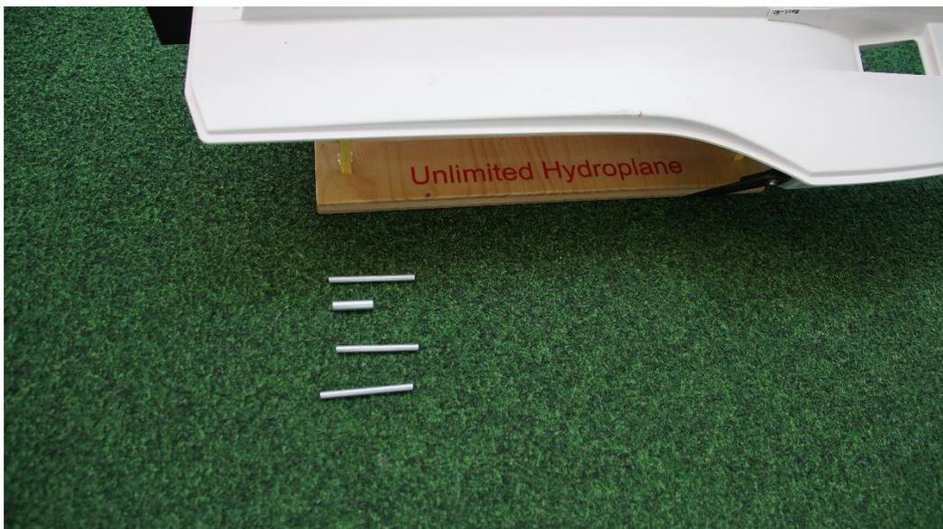
Die fertig zugeschnittenen Durchführungen für das Kühlwasser und das Rudergestänge
