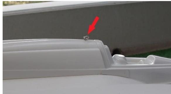
Die Haube ist hinten durch die beiden Auslassrohre für das Kühlwasser fixiert und vorne durch einen Karosseriesplint wie er bei RC-Cars üblich ist.
