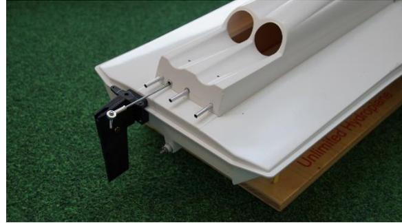
Ruder und Turnfin sind montiert und die Durchführungen eingeklebt
