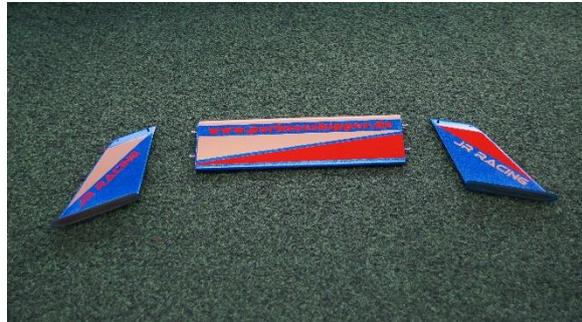
Für die vier Gleitpads an den Schwimmern habe ich dieses Mal nicht die serienmäßigen ABS-Teile verwendet, sondern eigene aus einer GFK-Platte angefertigt.
