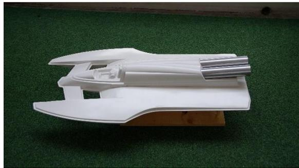
Die zugeschnittene und passend zugeschliffene Haube sowie die beiden Abgasrohre. Es fehlen noch Heckflügel, Ruder und Finne. Naja, und der Kopf des Piloten natürlich.
