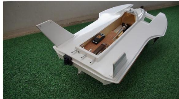
Die beiden Konsolenhalter sind mit Aceton angeklebt und die Spoiler-Konsolen eingesteckt aber noch nicht befestigt.
