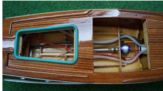
Hier ist das Boot bereits fertig lackiert, die ersten Beschlagteile angebracht sowie der Antrieb mit Fahrregler eingebaut
