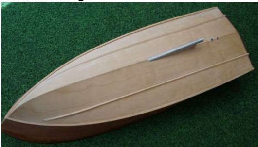
Um die Fahreigenschaften zu verbessern werden noch zusätzliche Gleitstringer angebracht
