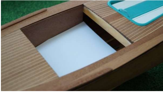
Hochzeit ! Deck und Rumpf werden verleimt
