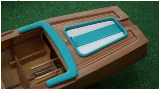
Die hintere Deckseinfassung wird ausgesägt und angepasst
