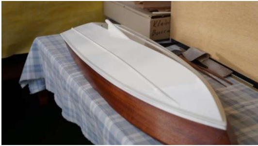
Das fertig lackierte Unterwasserschiff
