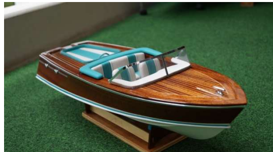
Hier ist das Boot bereits fertig lackiert, die ersten Beschlagteile angebracht sowie der Antrieb mit Fahrregler eingebaut
