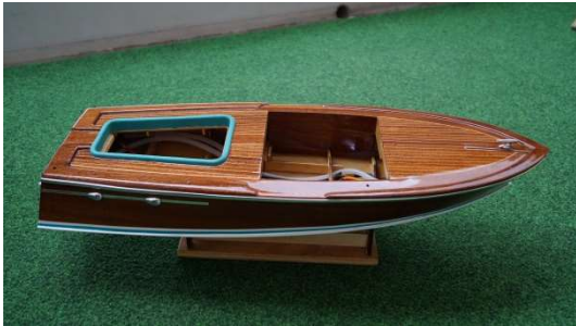
Hier ist das Boot bereits fertig lackiert, die ersten Beschlagteile angebracht sowie der Antrieb mit Fahrregler eingebaut
