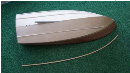
Um die Fahreigenschaften zu verbessern werden noch zusätzliche Gleitstringer angebracht
