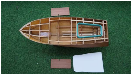
Die Seitenverkleidungen und die Schablone für den Boden
