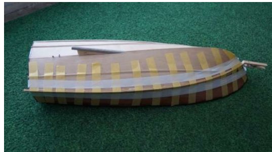
Um die Fahreigenschaften zu verbessern werden noch zusätzliche Gleitstringer angebracht
