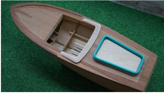
Der Ausschnitt für die Liegefläche ist ausgesägt
