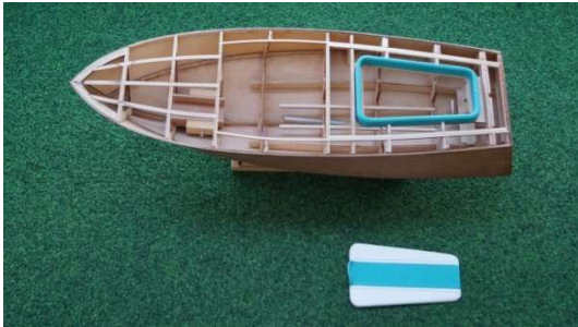
Die Umrandung der Liegefläche wird auf Hilfsspannen eingeklebt
